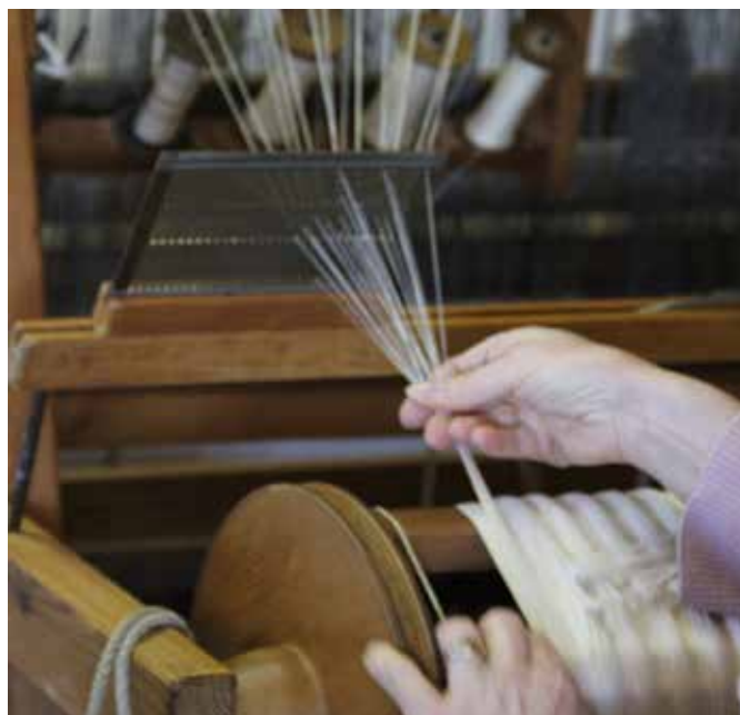
Ourdissage : opération préparatoire du tissage consistant à assembler les fils, dans l'ordre qu'ils occuperont dans l'étoffe.
